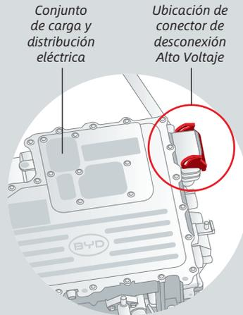
Luego abriendo el capó se debe desenchufar el conector de servicio que se encuentra en la parte superior del conjunto de carga y distribución eléctrica.
