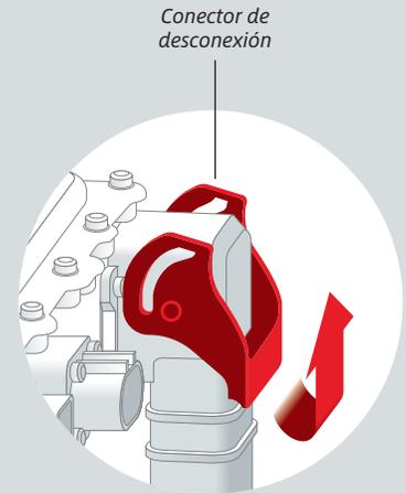
Como se muestra la figura se debe remover este conector, para desconectar todo el circuito de alto voltaje del vehículo.
