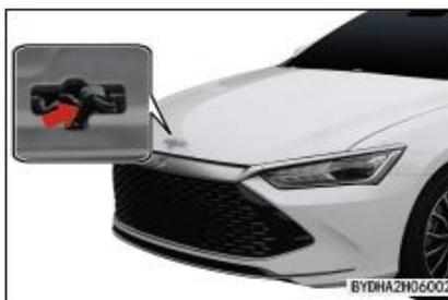
3. Levante la cubierta del compartimiento delantero, use la varilla de soporte para sostener la cubierta del compartimiento delantero.
