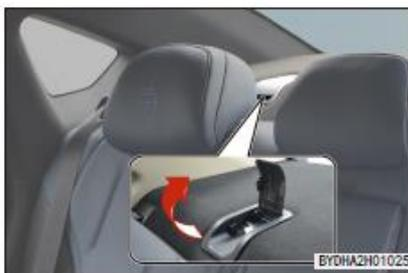
3. Sujete el gancho de sujeción en el soporte de anclaje de fijación, y fije la correa superior, asegúrese de sujetar firmemente la correa de parte superior.
