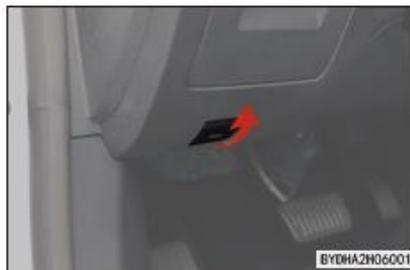
2. Abra la cubierta del compartimiento delantero y eleve la cubierta del compartimiento delantero hacia arriba.
