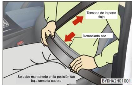
3. Inserte la lengüeta en la hebilla hasta que oiga el sonido "ka-da", tire la lengüeta en el sentido inverso, compruebe que el bloqueo sea con éxito. Tenga en cuenta de no distorsionar el cinturón de seguridad.
