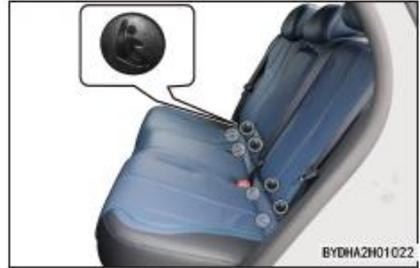
Se ha proporcionado el soporte de anclaje de fijación en los asientos del lado externo de la fila trasera (Se utiliza para la correa superior).
